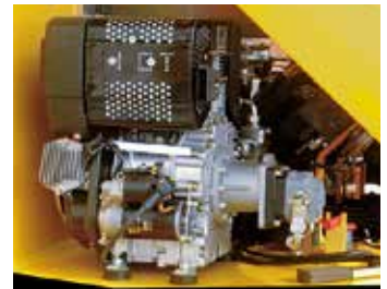
Motor endotérmico auxiliar.
