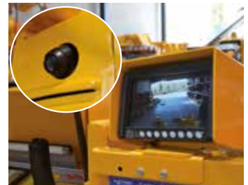
Telecámara para traslado.
