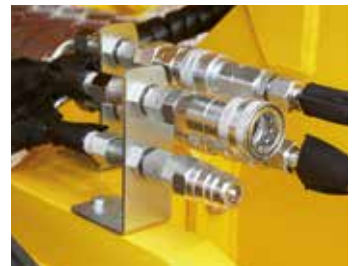
Dispositivo de frenado hidráulico del remolque.
